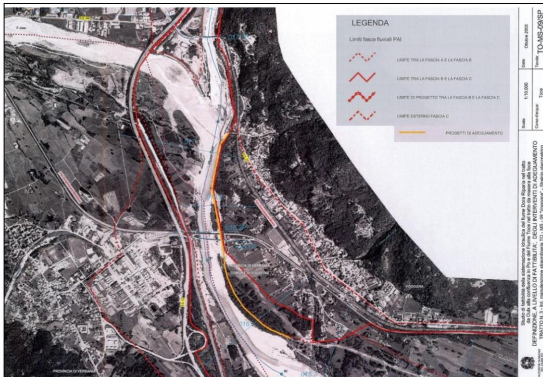
Figura 15 – Proposta di nuovo tracciato delle fasce fluviali del P.A.I. presentata nello “Studio di Fattibilità” (A.d.B.Po, 2003)
